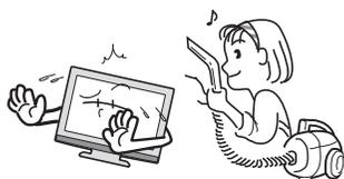
ときどきは電源コンセントや電源プラグの点検を長い間コンセントに電源プラグを差し込んだままにしておくと、ほこりがたまり、湿気が加わることで漏えい電流が流れ、火災の原因となることがあります。電源プラグがはずれかけていたり、破損したりしている場合は、特に危険です。
